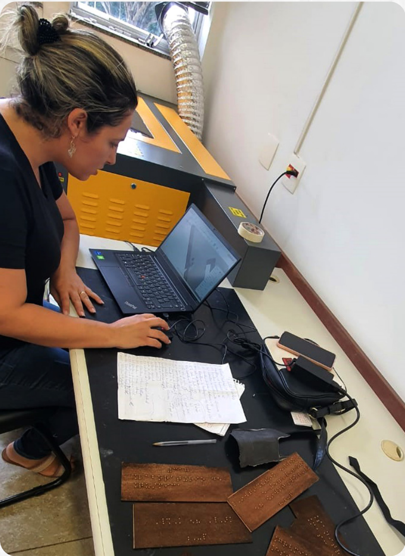
Do envio de modelo de placas para a impressora a laser, passando pelo teste em MDF até o resultado final de impressão em acrílico
